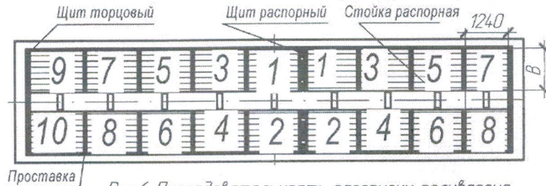
Рис.6 Последовательность разгрузки полувагона
