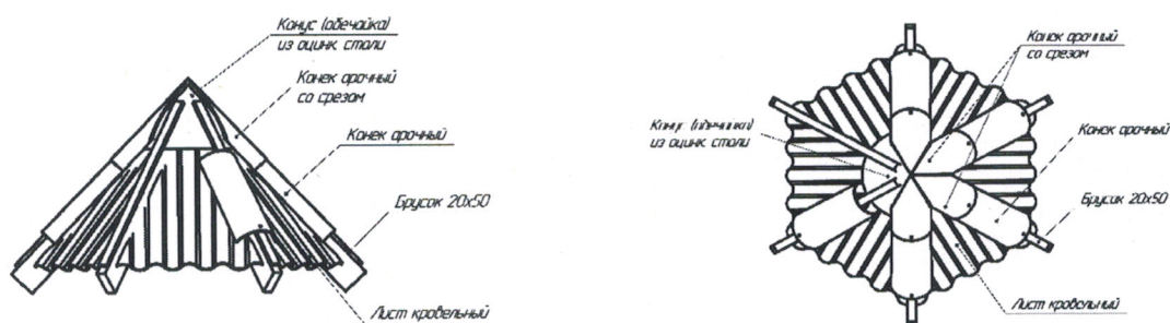
Рисунок 13. Крепления детали арочной коньковой для шатровой крыши
